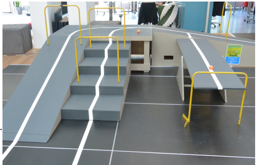
Figur 4: Rampe, plateau, trappe og vippe. De orange golfkugler på trappe og vippe er netop synlige. Gulvet er sorte felter med smalle aluminiumskanter.
